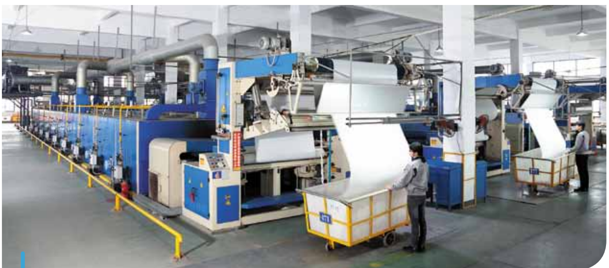
一家位於江蘇省蘇州市之紡織廠採用天然氣驅動之染整定型機。
