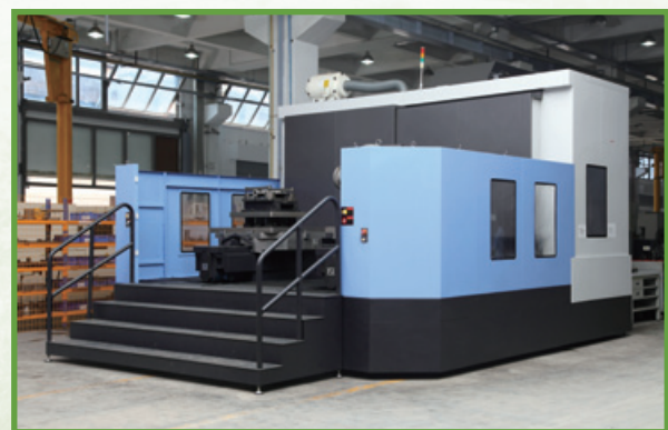
▲ 用於加工高精度鑄件產品的加工中心
