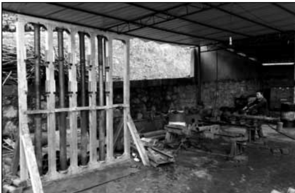
圖13-5：對拉蘇液壓支柱的維護作業及測試
