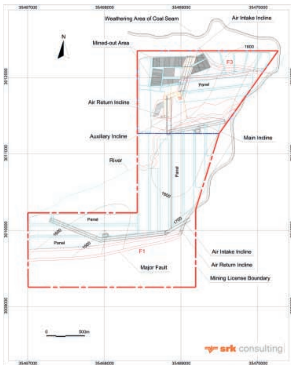
圖13-3：拉蘇煤礦的簡化採礦圖
