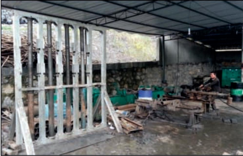
圖13-5：對拉蘇液壓支柱的維護作業及測試
