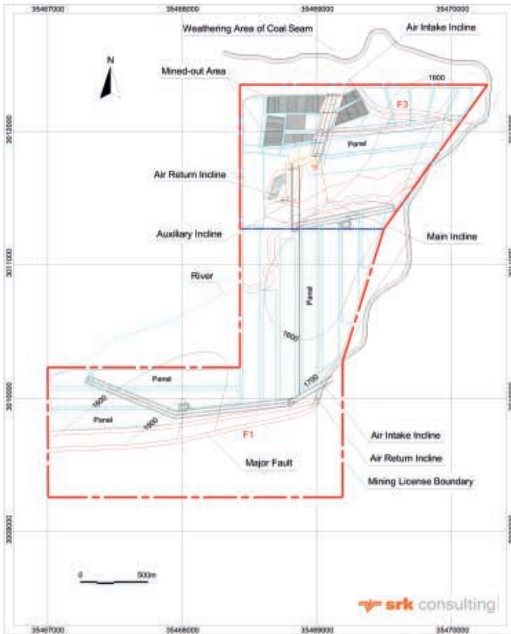
圖13-3：拉蘇煤礦的簡化採礦圖
