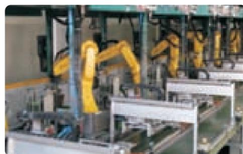
自動打磨濕式作業機械手杜絕粉塵產生
