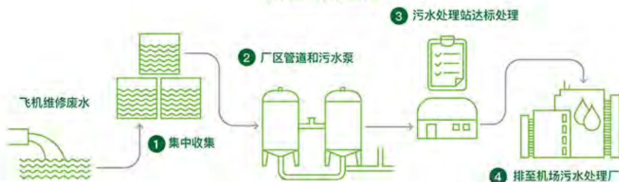
飞机维修废水处理流程
