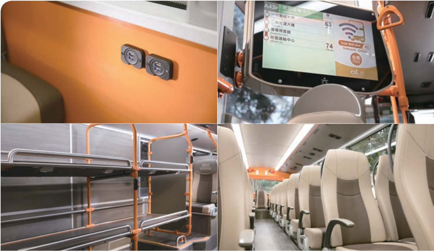
龍運 A 系列機場巴士裝置配合人體工學原理的座椅、免費 Wi-Fi 無線上網、USB 充電插座、寬敞行李架，以及巴士到站時間顯示屏
