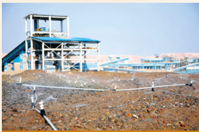
Mulishi項目堆浸系統1號堆場噴淋作業
