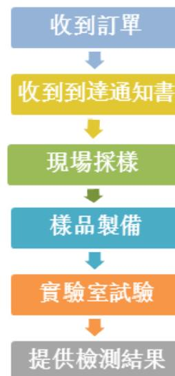
為了保證檢測結果的真實性、唯一性，杜絕人為因素對檢測結果的影響。所有檢測結果均嚴格遵從匿名制度進行和處理，綜合業務部接受樣品後，將明樣編制為盲樣，以盲樣形式進行樣品檢測，即實施盲樣化操作流程。具體來說，本集團具有資質的有關人員現場採集的所有樣品均裝入標有統一的保安代碼的安全密封袋中，以供識別。然後將所有樣品交予制樣車間，隨即以密封袋替換為隨機編排號碼的密封袋，車間及實驗室技術人員既不知道也不接觸煤樣的標識和來源。現場採樣、樣品製備和實驗室檢測由不同的工作單位實施以避免串通篡改實驗檢測結果。本集團在各服務中心的綜合業務部不參與樣品製備和測試過程，而是解釋保密代碼，並出具最後試驗證書或報告。本集團按嚴格要求僅向需瞭解情況的僱員授權以存取某一客戶儲存在資訊系統的檢測數據或結果，而在有關工作分配完成後，該數據的所有列印本及電子副本將會刪除。
