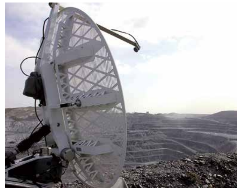
內蒙太平露天采坑邊坡監控雷達
