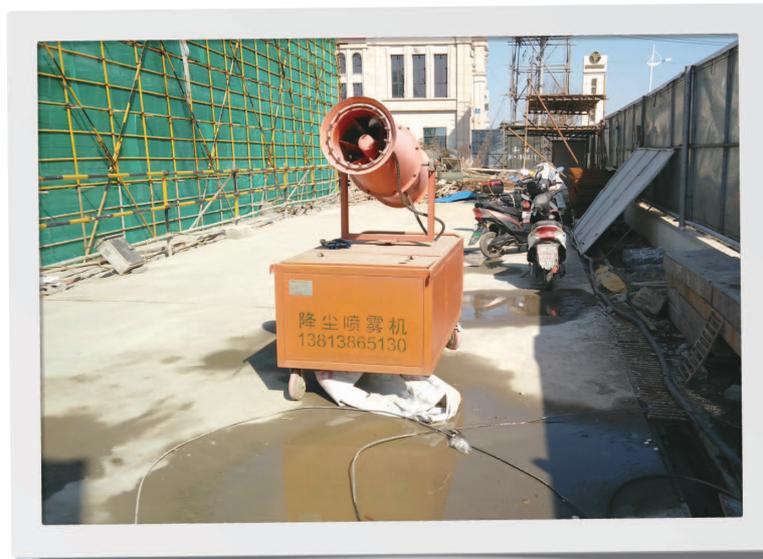
▲ 天璽灣項目建築工地中設置的防塵噴霧機
