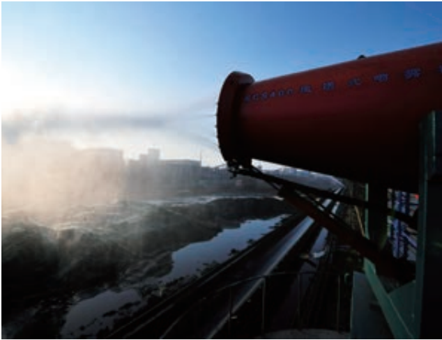
煤場防塵霧炮裝置
