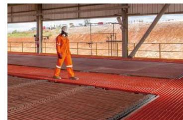
▲在TFM铜钴矿区电解厂的一名工人。开放式厂房和个人防护用品用于降低员工暴露于有害空气中的潜在危险
