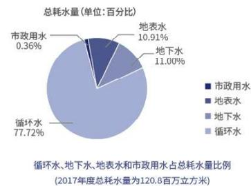
各矿区的水资源来源有所不同，这取决于各地可用资源情况，主要来源包括循环水和地下水。我们所有的矿区都利用循环水。加工用水将矿石加工产生的尾矿带到尾矿库。尾矿沉淀，回收表层清水，这样循环水可以在生产过程中被重复使用。
