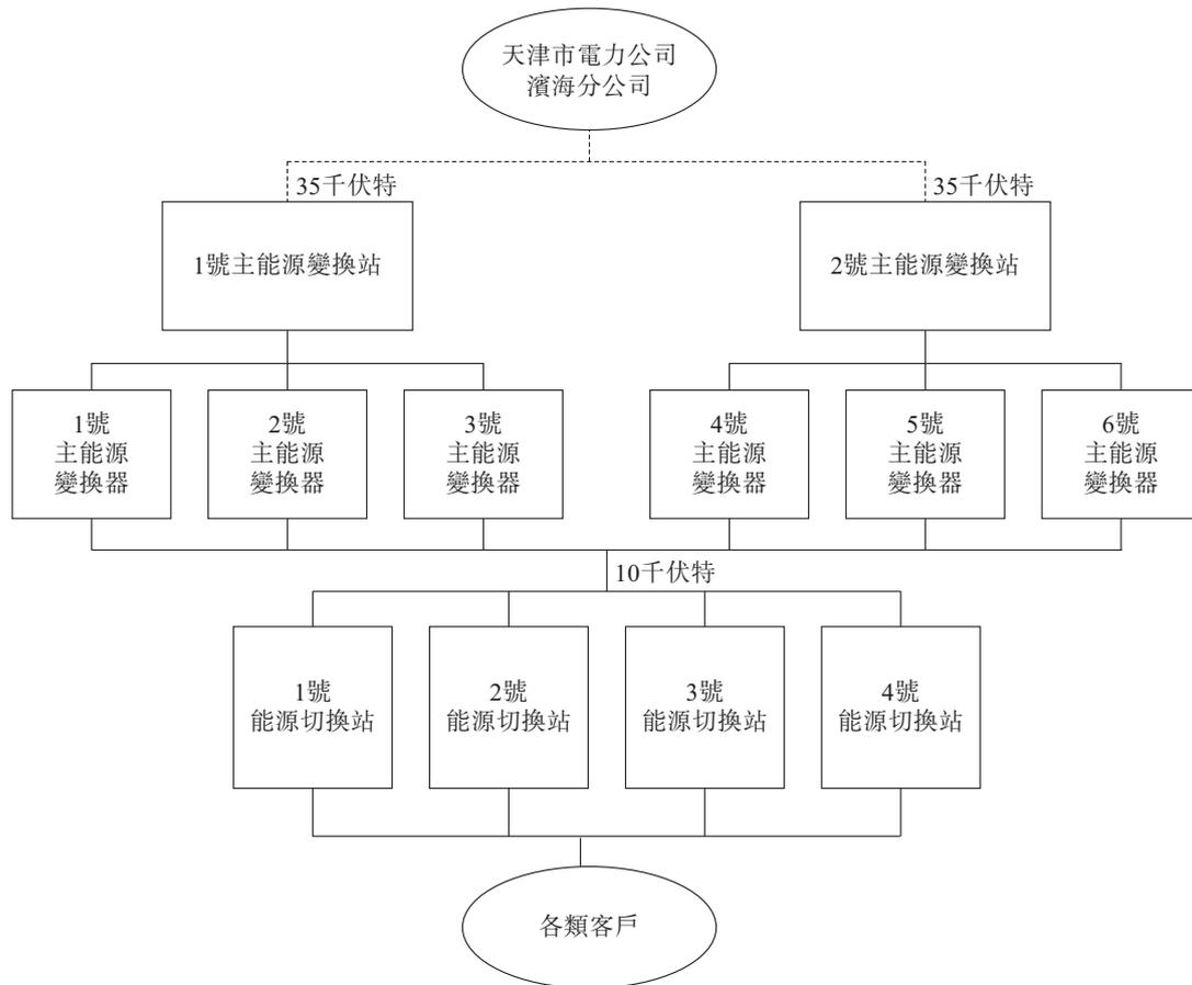
電力變換及配送流程主要包括兩個步驟：(i)將電量由35千伏特變換成10千伏特；及(ii)通過我們的能源切換站及電網向終端用戶配售電。
