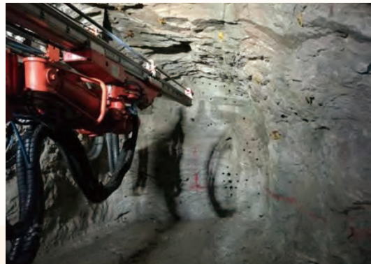
井下模擬生產培訓—DD422i鑿巖台車鑿巖
