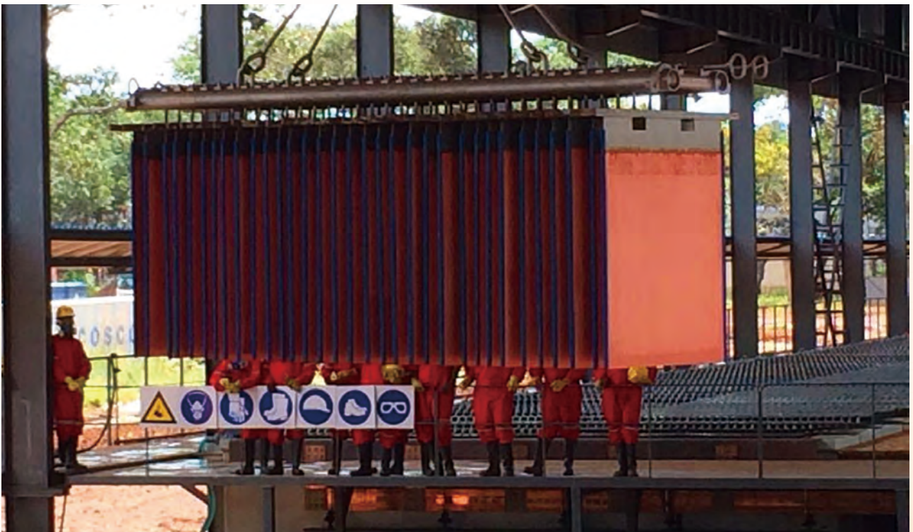
馬本德項目工人吊裝陰極銅產品
