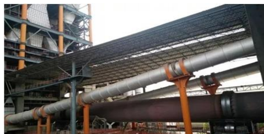
江西亚东#5#6 KHD \Phi 5.2 \times 61\text{m} 水泥短窑
