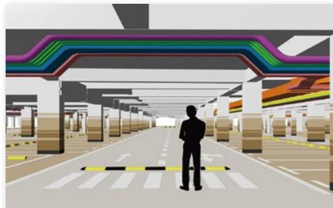
優化後：深化管綫，避免管綫碰撞，歸攏管綫，車道上的管綫做上翻處理，提高管綫下淨高。
