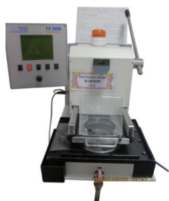
防水測試機 測試原材料的防水程度
