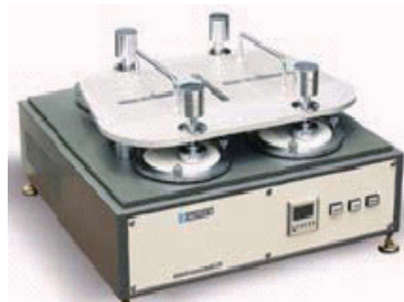
Martindale 磨耗機 評估紡織材料的耐磨性
