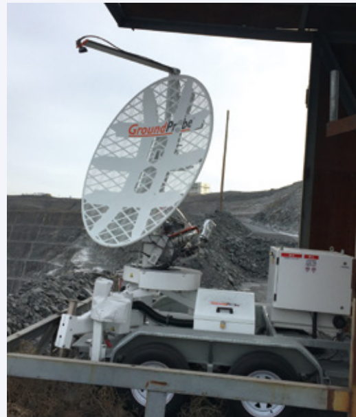
內蒙古太平露天采坑邊坡監控雷達
