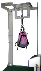
手袋把手震動檢測儀 測試成品所用扣環的強度及 成品的整體結構
