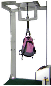
包把手震動檢測儀 測試成品所用扣環的強度及 成品的整體結構
