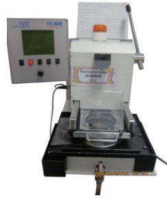
防水測試機 測試原材料的防水程度
