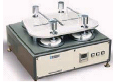
Martindale 磨耗機 評估紡織材料的耐磨性
