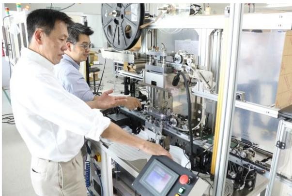
為了監控我們的產品及解決方案的素質，我們僅向符合本公司質量標準的指定供應商購買原料，並按時呈出交貨記錄。對於製造零件，鈹金零件和關鍵零件，都必須進行質量檢查。一旦集成了機器及軟件，項目團隊就會進行測試產品的運行以檢查其功能。項目團隊微調和校準產品以確保其功能符合客戶的規格要求。
