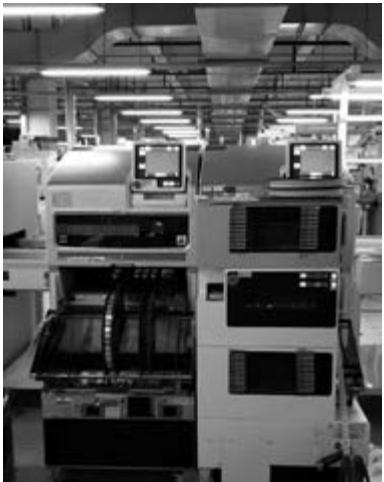
自動貼裝機透過貼裝頭選擇晶片、IC 及連接器等零件，並放置到 PCB 上。每張晶片的貼裝時間由 0.1 秒到 0.3 秒不等，可達致由 0.01 毫米到 0.05 毫米不等的高精度。組裝後，我們會進行目測以確認各零件是否有根據客戶要求或產品規格適當安裝。
