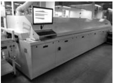
組裝後，PCB 將由輸送帶運送，通過回流爐以焊接零件。在回流爐中，電路板上的焊膏加熱並熔化以固定 IC 位置，其後熔化的焊膏冷卻，將 IC 連接於 PCB，此一步驟是將電子零件凝固並將其貼上 PCB。
