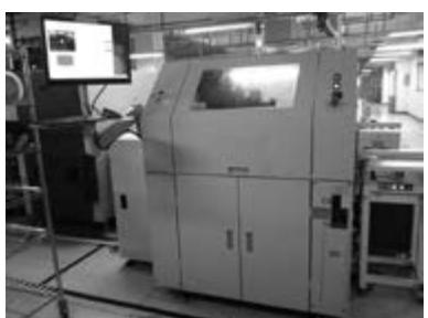
錫膏本質上是用於PCB並浮於強力助焊劑的粉狀金屬膏。自動印刷機在組裝前會將錫膏印刷在PCB上。有時，基於客戶的要求或產品規格，我們會透過自動化光學檢查(AOI)及／或目測確認錫膏是否有成功印刷。這是在PCB組裝後確認只有正確PCB部分用了錫膏貼裝，且零件有足夠的錫膏進行焊接的重要步驟。
