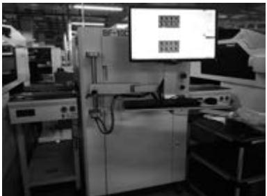
PCB 製造過程的 AOI 為以攝影鏡頭自動掃瞄受測試的設備，以找出災難性損壞(如零件缺失)及品質缺陷(如焊角大小或形狀或部件偏移)。由於這屬於非接觸測試方法，因此一般應用於製造過程中。機器視野系統光學式掃瞄 PCB 表面測出瑕疵。除 AOI 外，我們亦對半製成品及製成品進行目測。X 光檢測讓我們能夠看透 PCBA 各層，並清晰顯示 PCBA 的下層，可以找出 PCBA 的任何隱藏缺陷，此等步驟乃對較複雜或多層的 PCB 進行。
