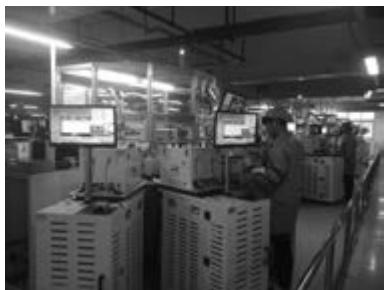
我們的員工或自動化測試機器會檢查產品的整體質素，並通過測試所有在製品、即時瑕疵分析及及時維修分析，確保其符合本集團及客戶的要求標準。製成品的測試包括目測並將PCBA放置按其速度運作，模擬PCBA的正常運作環境，以檢查PCBA的功能及符合其設計的情況。
