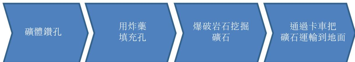
Orivesi礦目前的採礦方法是上向分層充填法，這需要定期在礦體上向上鑽孔，然後用炸藥填充孔並爆破岩石挖掘採礦石。然後將原礦石運輸到地面，然後通過卡車運送到Vammala工廠加工。我們在Orivesi礦的採礦作業目前專注於Kutema礦脈，截至2018年4月30日，距離地下約1,200米，黃金礦化被發現位於地下至少1,300米處。Sarvisuo礦脈是Orivesi礦的另外一個礦脈，延伸至地下約620米，於地面至160米處之間已發現額外黃金礦化。有關Orivesi礦採礦作業的更多詳情，請參閱本節「操作流程」一段。
