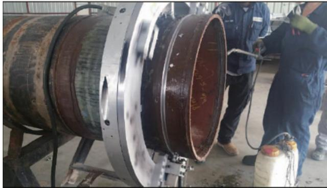
我們可以冷切方式切割直徑長達700毫米的鋼製輸氣管，故得以將切割現有輸氣管時引致火災的風險降至最低，這種切割輸氣管的方法較傳統的氧炔切割法更安全，更可取。
