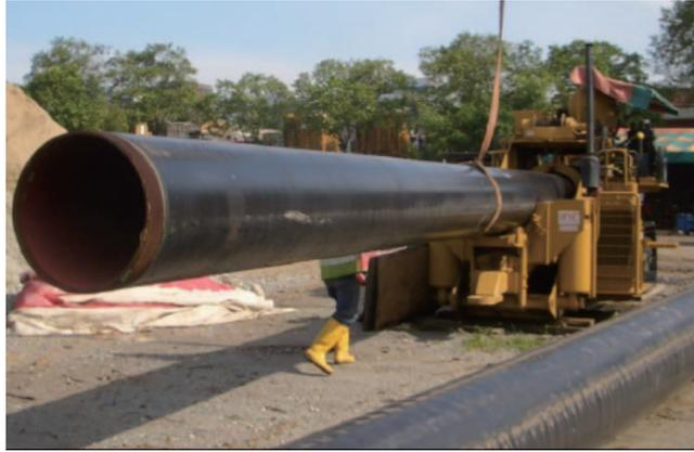
我們的冷彎機可彎曲直徑長達700毫米的鋼管，以配合任何環境及規劃設計。我們每次彎曲鋼管的角度可達15度，故得以避免在整齊排列管道上出現的任何微細阻礙。
