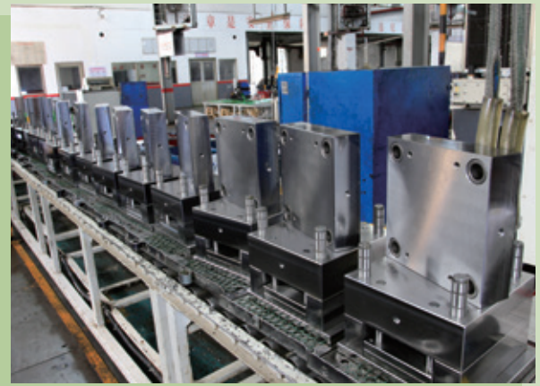
在標準模架生產線上組裝模架 Assembling standard mould bases on the production line
