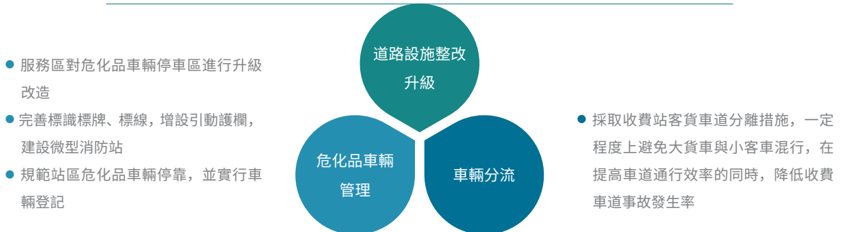
寧滬高速主要安全防護措施
