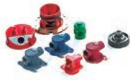
飛機液壓系統零件陽極氧化
