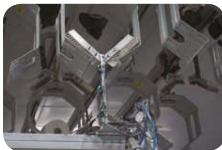
改造後設計加裝的V型毛刷
