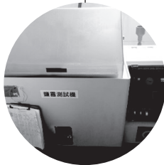
耐腐蝕性測試
