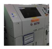
錫膏本質上是用於PCB並浮於強力助焊劑的粉狀金屬膏。自動印刷機在組裝前會將錫膏印刷在PCB上。我們會進行SPI以確認錫膏是否有成功印刷。這是在PCB組裝後確認只有正確PCB部分用了錫膏貼裝,且零件有足夠的錫膏進行焊接的重要步驟。
