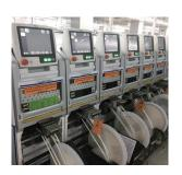
自動貼裝機透過貼裝頭選擇晶片、IC及連接器等電子元件,並放置到PCB上。放置後,我們會進行自動光學檢測以檢查各零件是否有根據客戶要求或規格適當放置。
