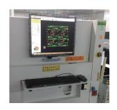
自動光學檢測指以攝像頭自動掃瞄受測試的設備,以找出災難性損壞(如零件缺失)及品質缺陷(如焊角大小或形狀或部件偏移)的過程。由於這屬於非接觸測試方法,因此一般應用於製造過程中。機器視野系統光學式掃瞄PCBA表面測出瑕疵。除自動光學檢測外,我們亦對半成品及製成品進行目視檢驗。X光檢測讓我們能夠看透PCBA各層,並清晰顯示PCBA的下層,可以找出PCBA的任何隱藏缺陷,此等步驟乃對較複雜或多層的PCBA進行。
