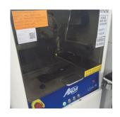
於裝配前,自動打印機將膠黏劑放置於PCB的適當位 置上以固定隨後放置的零件。
