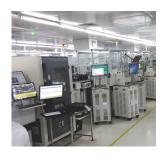
我們的員工或自動化測試機器會通過目視檢驗及模擬的方式調校PCBA的射頻信號部件及檢查PCBA的整體質量,確保其符合本集團及客戶的要求標準。
