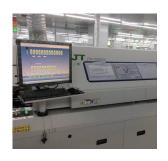
裝貼後,PCB將由輸送帶運送,通過回流爐以焊接零件。在回流爐中,電路板上的膠黏劑及/或焊膏加熱並熔化以固定電子元件位置,其後熔化的膠黏劑及/或焊膏冷卻,將電子元件固定在PCB。
