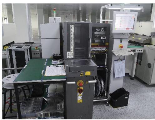
自動貼裝機使用真空貼裝頭揀選晶片、集成電路及連接器等部件，並放置到印刷電路板上。貼放後，我們會進行目測以確認各部件已根據客戶要求或產品規格妥當安裝。
