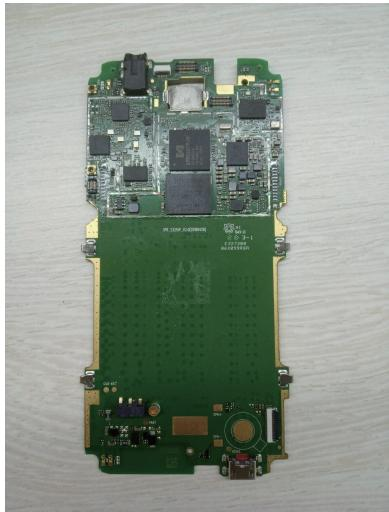
— 印刷電路板(PCB)為電子產品的核心組件。印刷電路板組裝(PCBA)是焊接電子組件到印刷電路板的過程。根據灼識諮詢報告，印刷電路板組裝可作為獨立產品售予下游用戶，以供通訊、電腦及消費型電子產品等各行業繼續生產各種電子產品。
