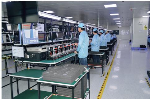
我們會人工或使用自動化測試機器測試印刷電路板組件的整體質量，確保其符合本集團及客戶的要求標準，方法為對所有在製品進行檢測、即時進行缺陷分析及及時進行維修分析。製成品的測試包括進行目測及對印刷電路板組裝進行測試、模擬印刷電路板組裝的正常運作環境，以檢查印刷電路板組裝的功能性及與設計的一致性。
