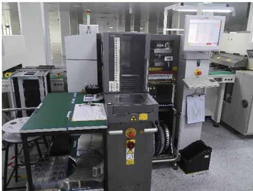
自動貼裝機使用真空貼裝頭揀選晶片、集成電路及連接器等部件，並放置到印刷電路板上。貼放後，我們會進行目測以確認各部件已根據客戶要求或產品規格妥當安裝。
