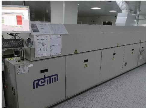
貼裝後，印刷電路板將由輸送帶運往回流爐進行部件焊接。在回流爐中，電路板塗抹的焊膏會受熱融化使集成電路固定，再使熔化的焊膏冷卻，將集成電路銜接於印刷電路板，使電子部件黏附於印刷電路板之上。
