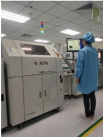
錫膏透過絲網印刷程序利用焊錫印刷機塗在PCB上。焊錫印刷機乃利用模板噴塗錫膏。其後，PCB會被傳輸至自動點膠機。
