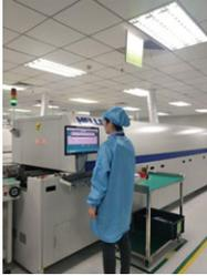
貼裝過後，PCB將由輸送帶運送，通過回流爐以焊接元件。在回流爐中，PCB上的錫膏被加熱並熔化以固定集成電路位置，其後熔化的錫膏冷卻，將集成電路貼附於PCB上。此步驟旨在將電子元件加固並將其貼在PCB上。
