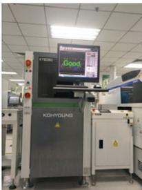
在此階段，PCB還會被進一步傳輸至焊錫檢查機接受自動焊錫厚度檢查。
