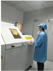
(ii) X光檢查(如有必要)，其令我們可透視PCB各層，並清晰顯示PCB的下層，從而可找出任何隱藏缺陷(如適用)；及
