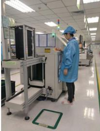
包括PCB及電子元件在內的材料乃通過PCB裝填器裝填和傳輸。
