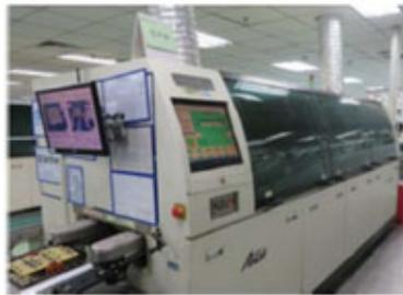
經插入元件的PCB會被浸入錫膏熔融槽機 (molten solder tank machine)，在其內泵機的作用下，融化的錫膏會起伏波動。當PCB與融化的錫膏波接觸時，元件即會被焊接到PCB上以生產PCBA。
