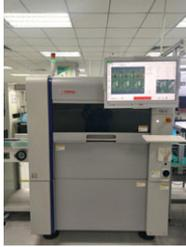
(i) AOI(自動光學檢測)，此程序下攝像頭會自動掃描接受檢測的PCB，以檢查元件缺失及質量缺陷(如大小或形狀偏差)情況；
