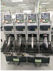
自動貼裝機透過貼裝頭選擇晶片、集成電路及連接器等元件，並安置到PCB上，可達致0.03毫米到0.04毫米不等的高精度。
