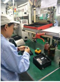
我們的員工或自動化測試機器會檢查我們產品的整體質素，並通過測試所有在製品、即時瑕疵分析及及時維修分析，確保其符合規定標準。產品測試包括目測及功能測試，其涉及模擬產品的正常運作環境。
