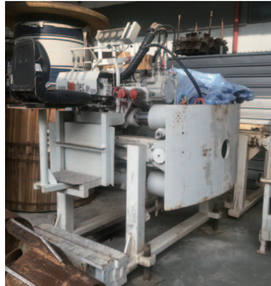
用於頂管施工的螺旋鑽孔機
