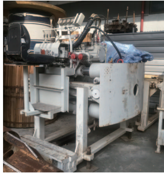
用於頂管施工的螺旋鑽孔機
