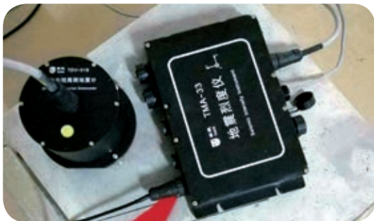
▲ 利用鐵塔機房部署地震監測裝置
