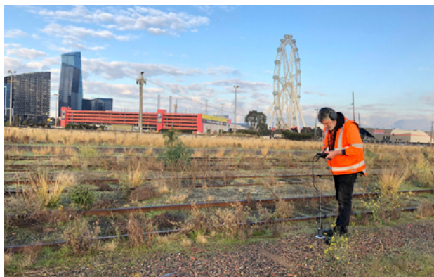
檢查漏水情況
