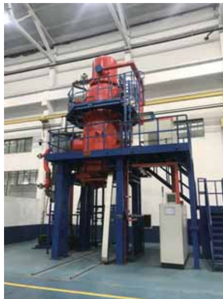
圖中是位於寧波其中一個廠區熱處理車間的真空淬火爐。
