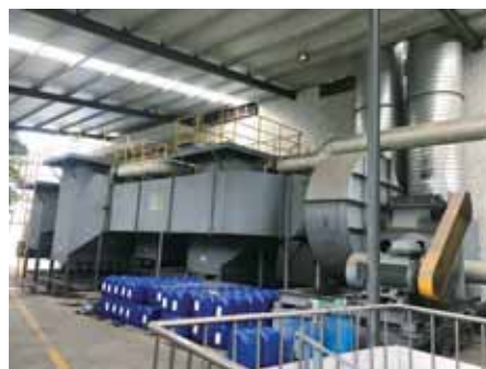
圖中是位於寧波其中一個廠區的噴漆房及廢氣處理設施
