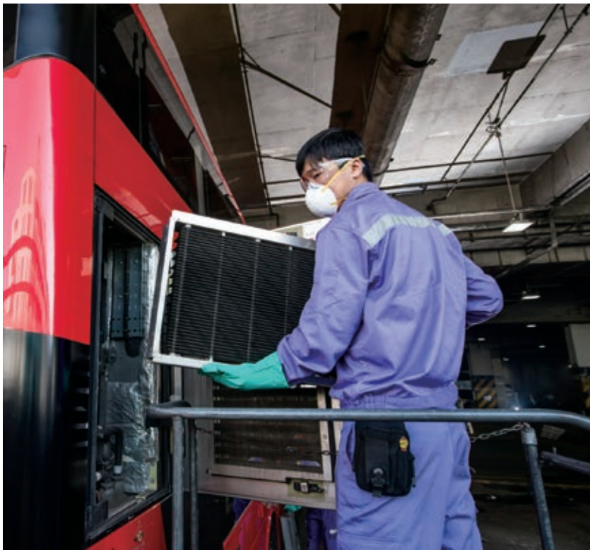
○ 新一代環保冷氣系統備有電子隔塵網，有助改善車廂內空氣質素
