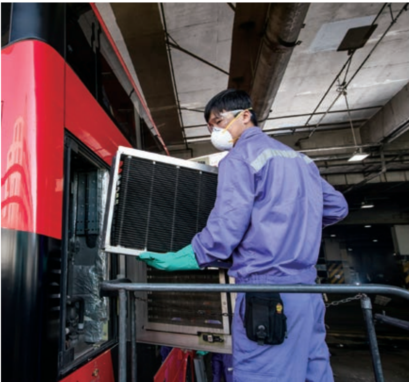
○ 新一代環保冷氣系統備有電子隔塵網，有助改善車廂內空氣質素
