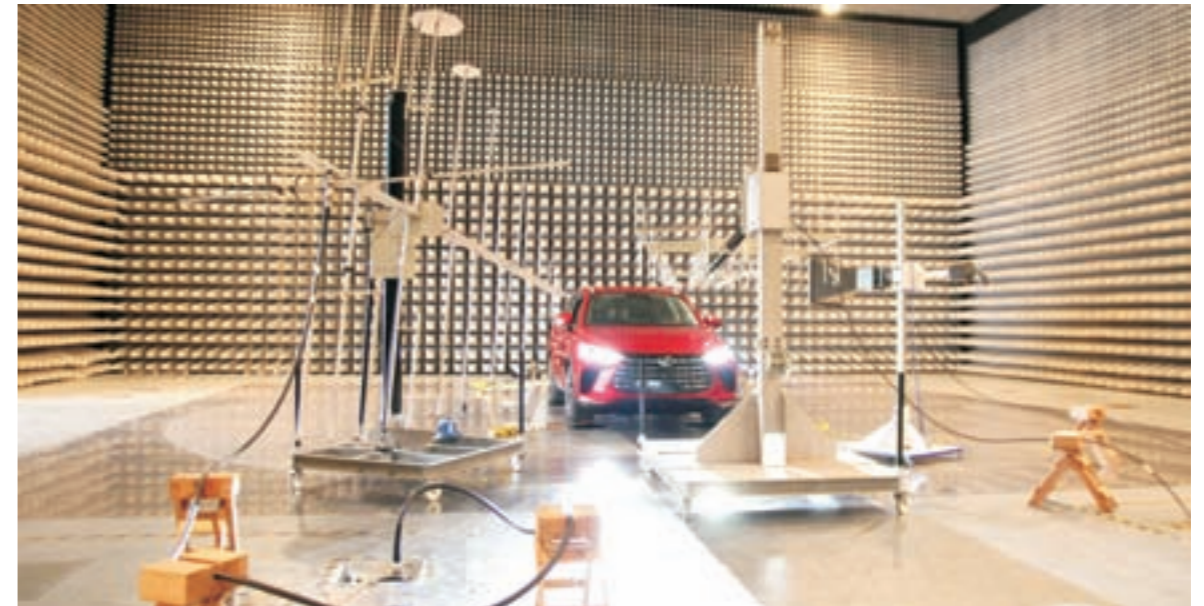
▲ 整車EMC測試場景
