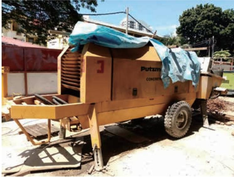
混凝土泵為一個可移動的泵，用於透過管道裝載地面的混凝土至較高層數，作進一步處理。於最後實際可行日期，我們擁有三部混凝土泵。
