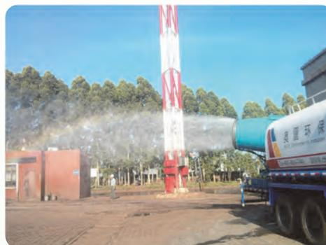
大功率霧炮機的射程可達35-45米，形成的細小水霧顆粒能夠有效減少揚塵。
