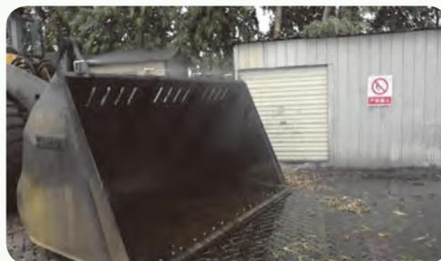
通過在裝載機加裝噴淋系統，從鏟斗工作裝置前端進行水霧噴淋，改善裝卸過程中產生的揚塵情況，達到生產作業和滿足環保需求的目的。
