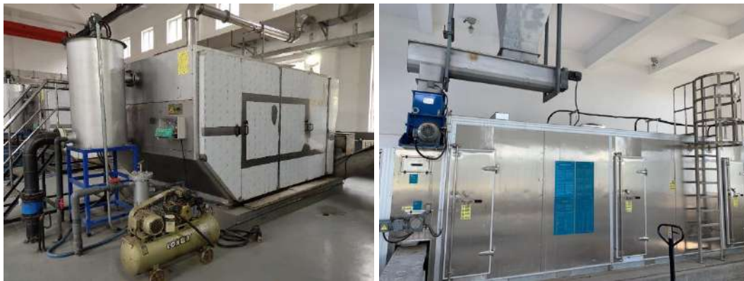
圖 16：華北分部的污泥脫水帶式壓濾機（左圖），以及華南分部的污泥幹化系統（右圖）。
