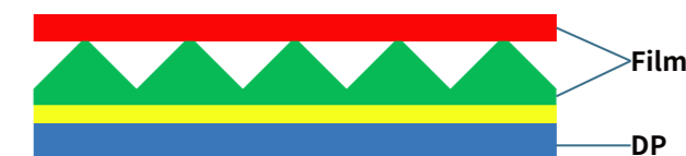
光學膜片與擴散板貼合示意圖（Film：光學膜片；DP：擴散板）
