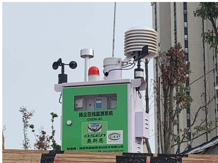
設置於工地的空氣質素監測系統
