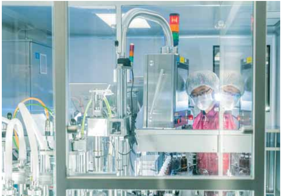
本集團旗下新科製藥有限公司 的PIC/S GMP認證製造設施— 理瓶及口服液灌裝機
