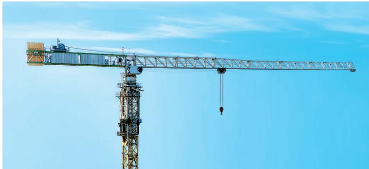
塔頭式塔式起重機的設計側重於安全性及可靠性。塔頭式塔式起重機的臂架截面較小，故受力能力更佳，抗過載能力出色。相較其他型號的塔式起重機而言，臂架截面較小的塔頭式塔式起重機承載的力度因其採用的拉桿結構而減小，此意味著塔頭式塔式起重機的使用壽命通常較長。塔頭式塔式起重機的運輸成本因其拉桿結構而相對減少。塔頭式塔式起重機因其應用範圍廣而為塔式起重機服務行業使用最廣泛的塔式起重機。於最後可行日期，我們擁有301台塔頭式塔式起重機，及我們最大的塔頭式塔式起重機的最大起重能力為1,200噸米。
