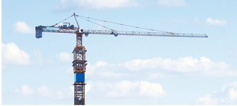
動臂式塔式起重機配備先進回轉機制，可有效增強受力能力及水平剛度。動臂式塔式起重機主體尾端的回轉半徑較小。由於動臂式塔式起重機可於旋轉時將其臂架上舉，故可避免在狹窄場地臂架與周邊樓宇的碰撞情況發生（尤其是在城市中心的拆建或改建工程中）。動臂式塔式起重機的起重力矩大且作業幅度廣，可在建造高層樓宇時發揮優勢。動臂式塔式起重機高度靈活，易於在狹窄空間操作。由於其技術規格要求，動臂式塔式起重機通常用於商業物業的建造。於最後可行日期，我們擁有33台動臂式塔式起重機，及我們最大的動臂式塔式起重機承受的最大起重能力為720噸米。
